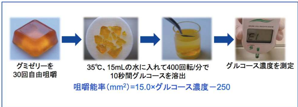
図 2. 咀嚼能率の測定方法
